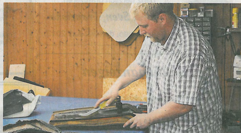
Mitarbeiter Sven Tietje entrostet eine Sitzbank, damit anschließend der neue Bezug aufgeklebt werden kann
